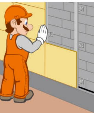
Установка панелей на систему навесного вентилируемого фасада
