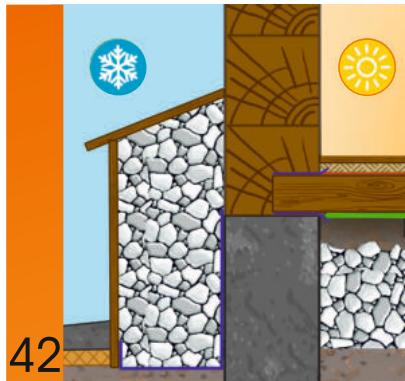
Насыпной утеплитель из автоклавного газобетона отлично подходит для устройства теплоизолирующих засыпных конструкций (завалинка). Толщина стоя определяется проектом
