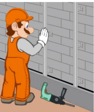
Крепление кронштейнов системы навесного вентилируемого фасада производить с помощью анкеров. После крепления кронштейнов произвести монтаж профиля
