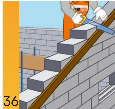
Для формирования необходимого наклона кадки использовать **ножковку и рубанок для газобетона** (см. инструменты). Поверх стены устраивается антисейсмический (армированный) пояс с применением **U-образных блоков**
