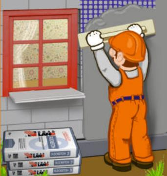
Просохшую после пропитки поверхность оштукатурить **тонкослойной гидрофобной цементной штукатуркой Krasland ГАЗОБЕТОН-3** с использованием штукатурной сетки (толщина слоя 0,5 - 1 см.)
