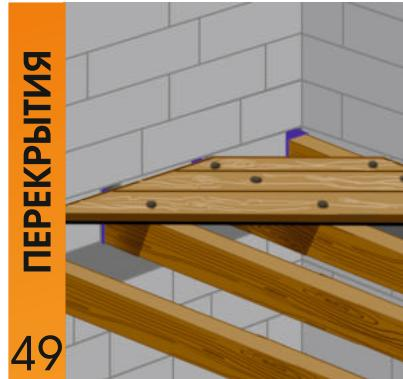
Балки перекрытий (покрытий) следует конструктивно связывать с антисейсмическим поясом и устраивать по ним сплошной дощатый диагональный настил
