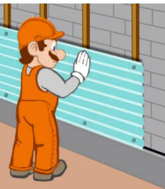
Монтаж металлосяйдинга на систему навесного вентилируемого фасада
