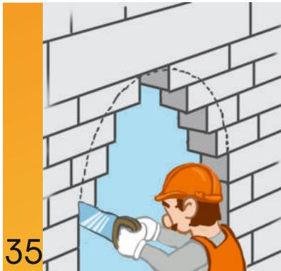
Оконные и дверные проемы сложной формы легко вырезаются **ножковкой по газобетону** (см. инструменты)
