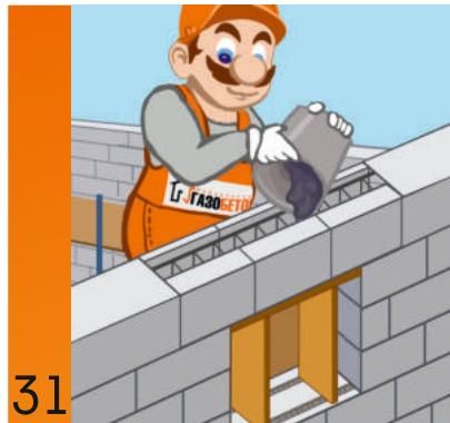
U-образный блок заполняется тяжелым бетоном
