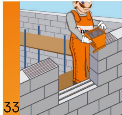
На участки опирания перемычек наносится клей при помощи **зубчатой каретки или кельмы для клеевого раствора** (см. инструменты).
