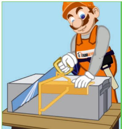
**Ножовка** для резки автоклавного газобетона позволяет изготавливать доборные блоки любых размеров непосредственно на строительной площадке. Изготовлена из высоколегированной закаленной стали с твердосплавным покрытием режущих кромок зубов. Для точности распила и безопасности рекомендуем применять вместе с угольником. **Угольник** применяется для обеспечения точности и соблюдения прямых углов при резке блоков.
