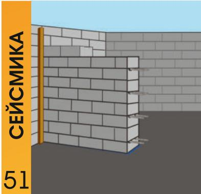
Необходимо армировать первый и каждый второй последующие ряды кладки газобетонных блоков. Для стен толщиной 400 мм необходимо применять не менее двух стержней d 8мм
