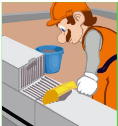
**Кельма** для клеевого раствора - это эффективный инструмент для нанесения клея на вертикальные и горизонтальные поверхности блоков, для ведения кладки и строительства стен сложной конфигурации. Выпускаются шириной 100, 200, 300 и 400 мм.
