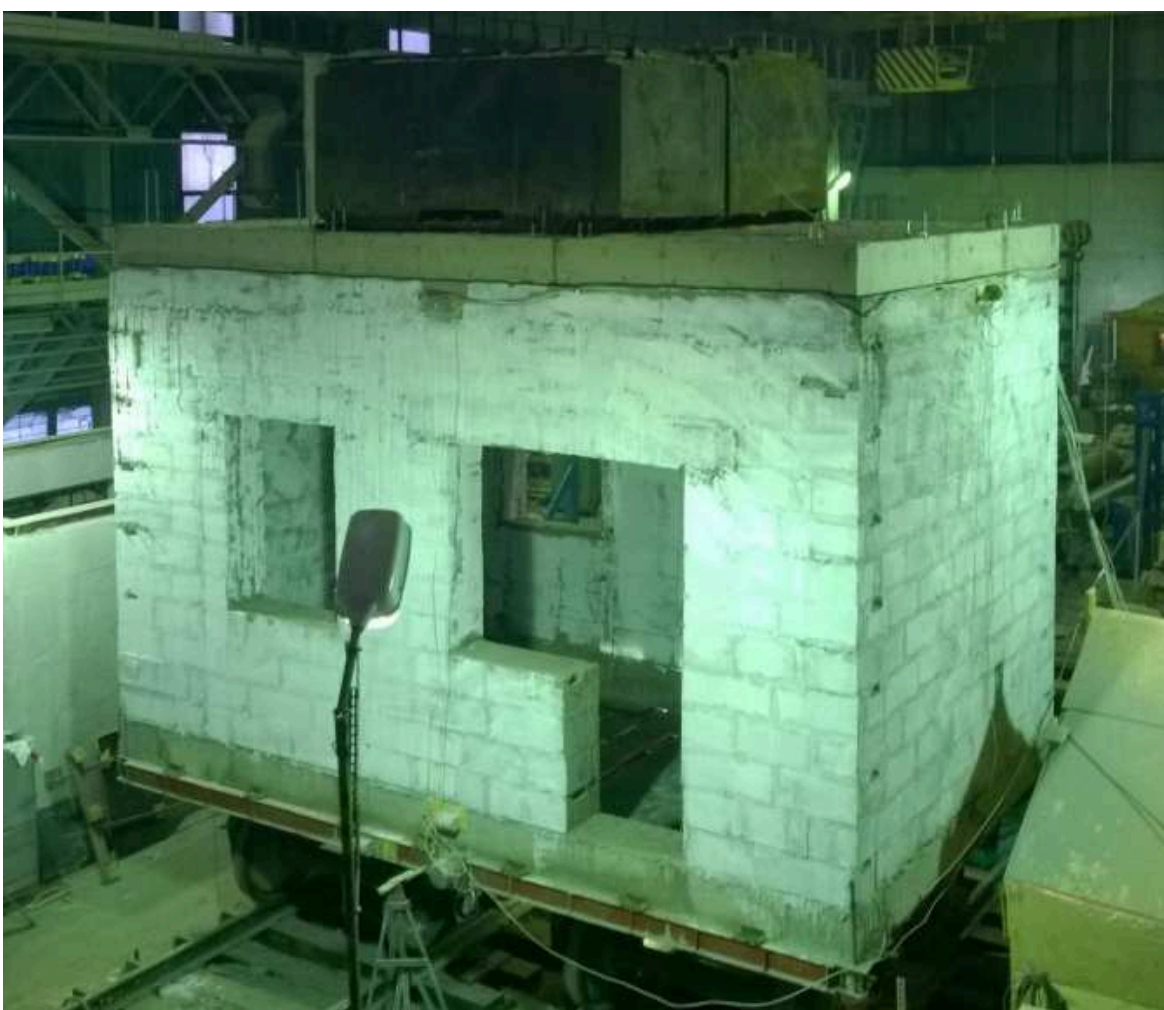
Фото 7. Опытный фрагмент после установки плит покрытия и элементов пригруза
